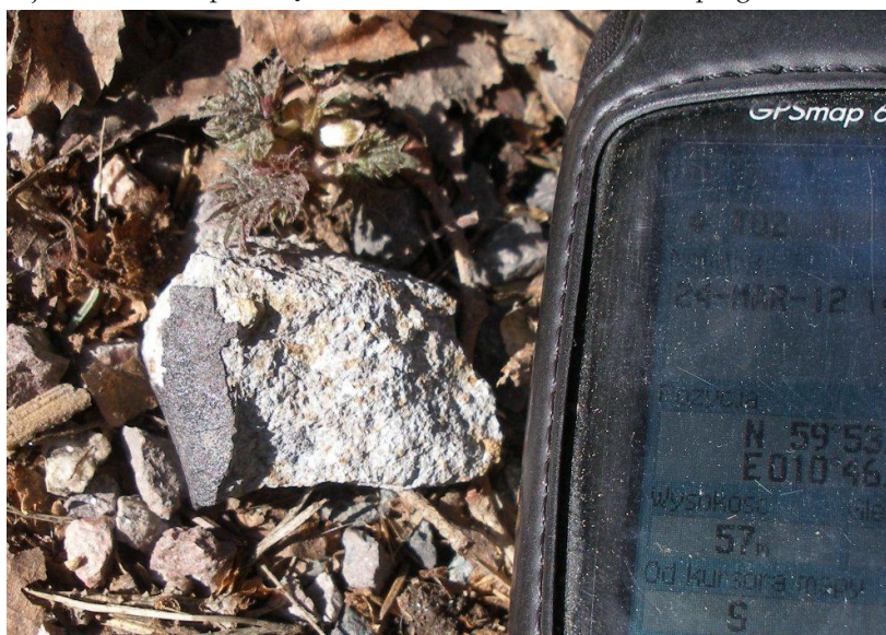
Fot. 1. Badany fragment meteorytu z Oslo in-situ, m=32,5g (fot. T. Kubalczak).
