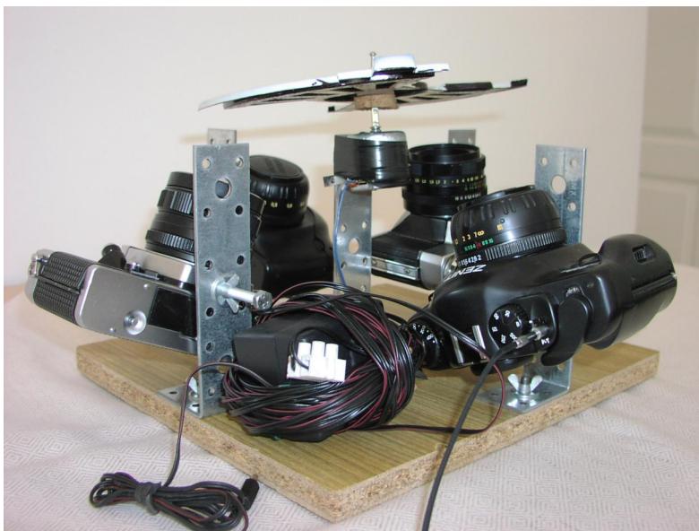
Shutter wraz z czterema aparatami do monitoringu nieba
